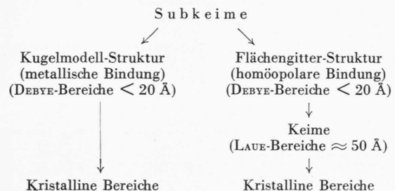
Abb. 3. Kristallbildung aus der Metallschmelze in schematischer Darstellung.
